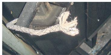
Dichtungsschnüre von Öfen oder Cheminées bestehen oft teilweise aus Asbest.
